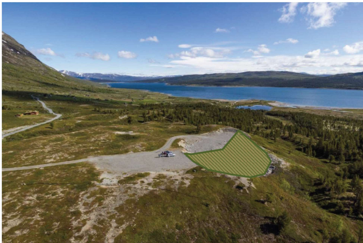
Illustrasjon 8. Illustrasjonen viser kva for område som i landskaps- og miljøplanen vart sett av for permanent deponi for stein som var sprengt ut av tunnel frå kraftutbygginga i Smådøla (kjelde "Landskaps og miljøplan" Norconsult AS).
